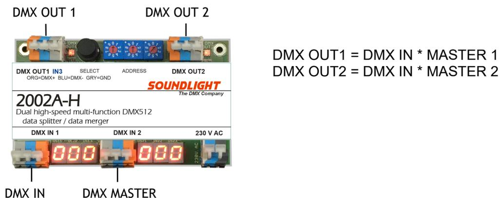
Bei nicht belegtem DMX MASTER Eingang wird automatisch ein Master-Wert von 100% angenommen. Die Displays zeigen daher beide „100“ an und das Eingangssignal wird unverändert durchgeroutet.
